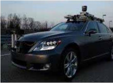
**Lexus AASRV Vehículo autónomo.** vehículo equipado con cámaras, radar, un sistema láser para reconocer su entorno y comunicarse.
